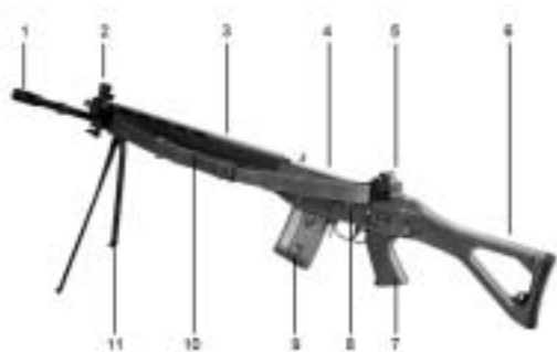
Bild 1: Bestandteile des 5,6 mm SIGAR 90 1 Lauf 7 Pistolengriff 2 Kornschutz 8 Abzuggehäuse 3 Handschutz 9 Magazin 4 Verschlussgehäuse 10 Tragriemen 5 Optiker-Visier 11 Zweibeinlätze 6 Kolben
